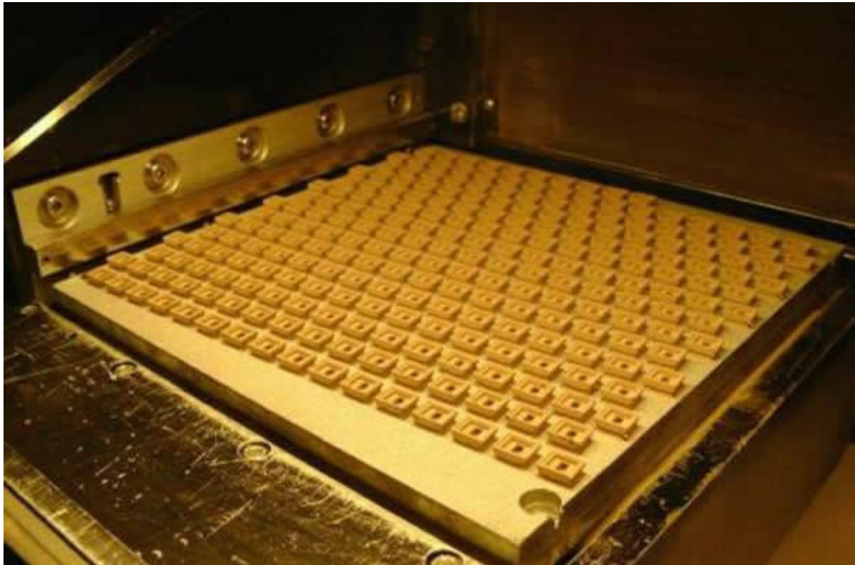
Abb. 5: Ein Job mit mehr als 200 Teilen in einem EOSINT M 50 Xtended System
