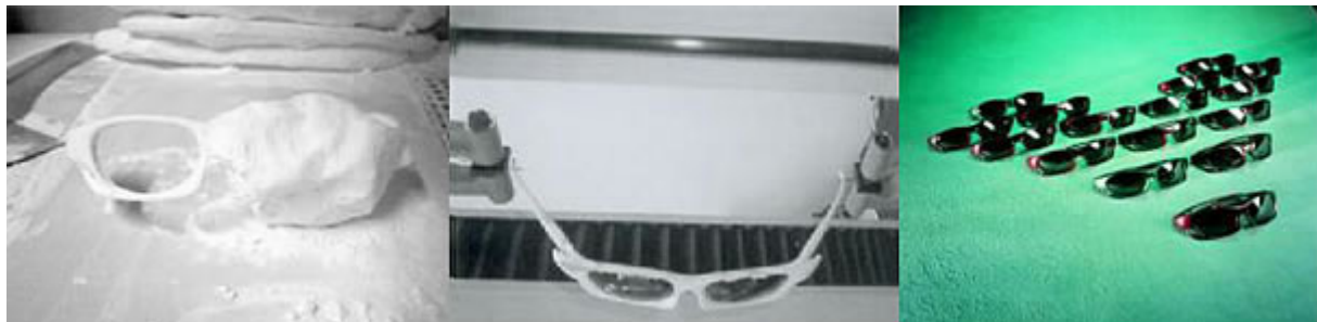
Abb. 11: Designer-Sonnenbrillen mit e-Manufacturing™ Laser-Sintern der Gestelle (links), Festigkeitsprüfung (mitte), fertiges Produkt limitierte Auflage in verschiedenen Designvarianten (rechts)
