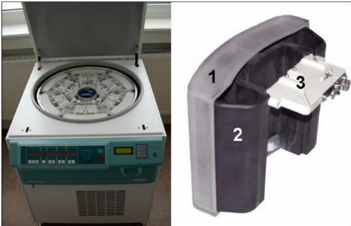
Abb1:Links: ROTOMAT Zentrifuge; Rechts: Auffangschale (1), Gehäuse (2) und Spannplatte (3).
