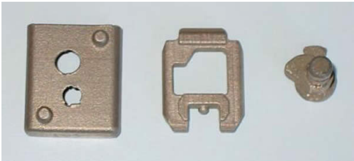
Abb. 4: Die drei lasergesinterten Metallkomponenten einer Computerverriegelung
