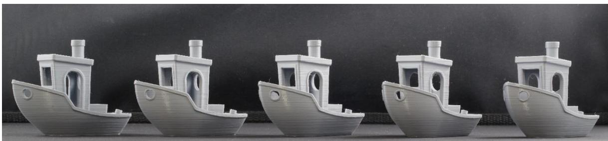
Abbildung 4-6 Visueller Vergleich der gedruckten Testkörper. Ganz links steht der Testkörper des ersten Zyklus (R0), ganz rechts der Probekörper des letzten Zyklus (R4)
