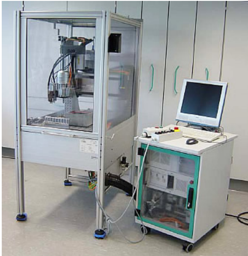
Abb.2: pc pro ®-Anlage zum Gießen und Fräsen von Kunststoffteilen
