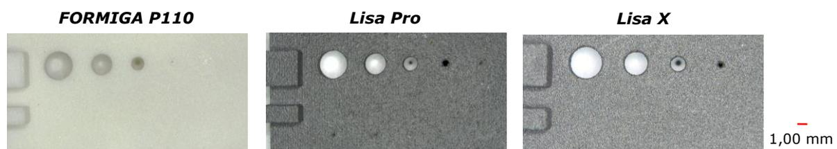
**Abbildung 6: Mikroskopieaufnahmen der Auflösungsstestlöcher von 4,00 mm bis 0,10 mm**
