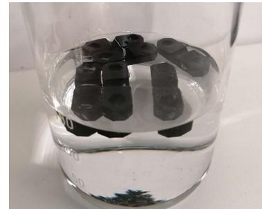
Abbildung 3: Probenkörper in Klimakammer mit Aufbewahrungsbehälter (links) und im Wasserbad (rechts)
