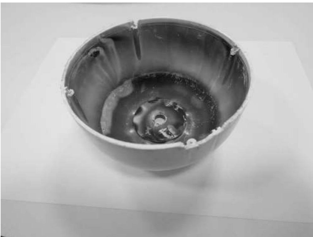
Abb. 3 Trafoglocke mit Temperaturverfärbungen und gebrochenem Gewinde
