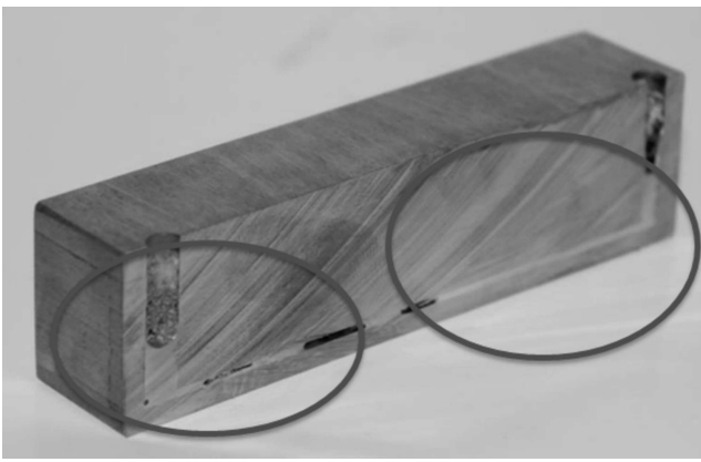
Abbildung 6: Links: innere Kanäle gefüllt mit Lotwerkstoff; rechts: unerwünscht große Poren in der Fugestelle
