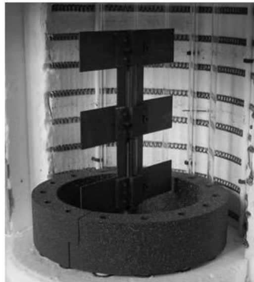
Abbildung 4: Eingesetzter Auskleidungsring mit innen liegendem Rührwerk
