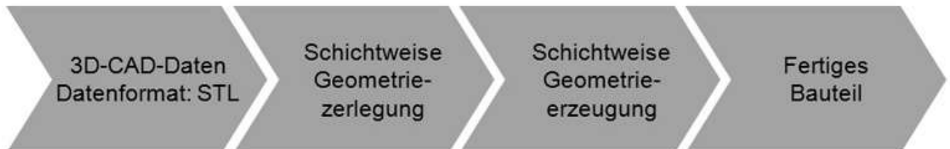
Abbildung 1: Prinzipieller Verfahrensablauf bei der additiven Fertigung.
