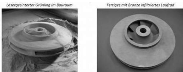
Abbildung 8: Kreiselpumpenlaufrad
