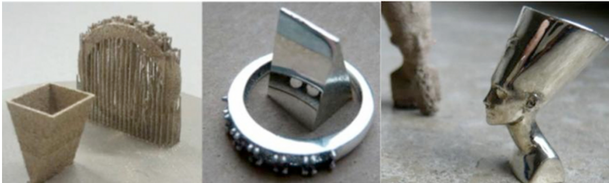
Abbildung 11 generativ gefertigte Bauteile aus Silber: Keil und Ring: links nach Prozess, mittig nach Post-Processing; Nofretete: im Hintergrund mit Supportstruktur nach Prozess, im Vordergrund nach Nachbearbeitung
