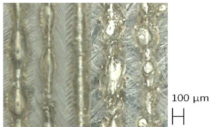
Abbildung 4 Lasergesinterte Einzelspuren mit verschiedenen Belichtungsgeschwindigkeiten (von links nach rechts): 80, 125, 250, 750 mm/s
