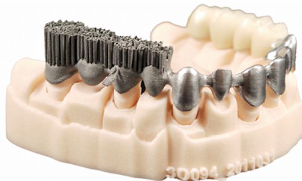
Abbildung 7: Prozess auf einen Blick: Lasergesinterter Zahnersatz (mit Supportstrukturen; Oberfläche bereit zur Verblendung; nach keramischer Verblendung) auf lasergesintertem Dentalmodell (Quelle: EOS GmbH).
