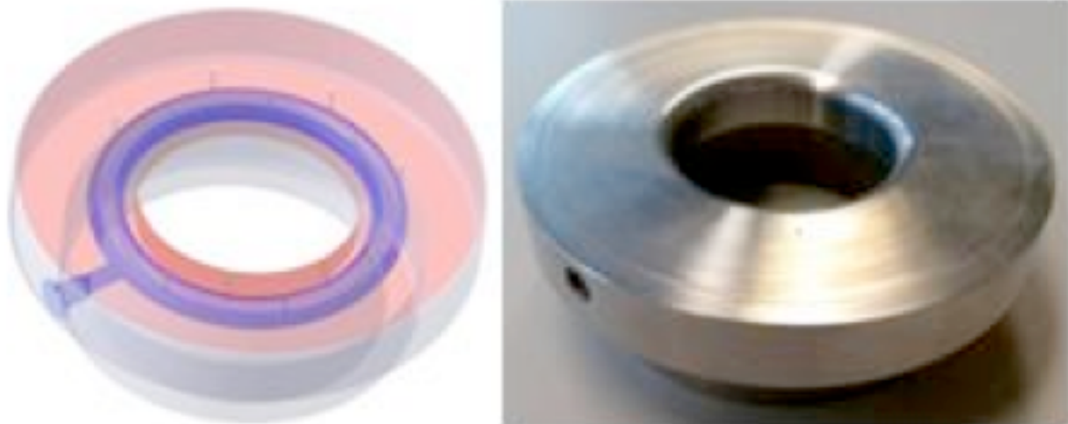
Abbildung 8: Matrize mit integriertem Schmierstoffsystem, schematische Darstellung (links) und mittels SLS-Verfahren gefertigtes Werkzeug (rechts) Werkstoff: CL50WS
