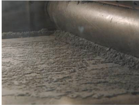
Bild 2: Ansicht des Pulverbettes in einer SLM-Anlage mit stark ausgeprägten Unebenheiten im Pulverauftrag
