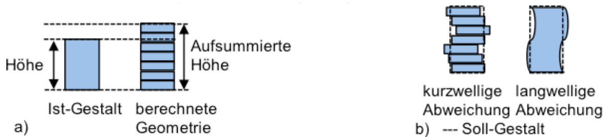
Bild 4: a) Stapelfehler bei Berechnung eines Volumenmodells aus einzelnen Schichten aufgrund ungenauer Höheninformationen; b) Gestaltabweichungen aufgrund von Führungsabweichungen des Pulverbettes
