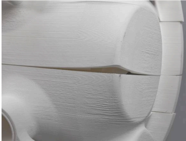
Bild 1: Defekt eines additiv gefertigten Bauteils aufgrund von Curling
