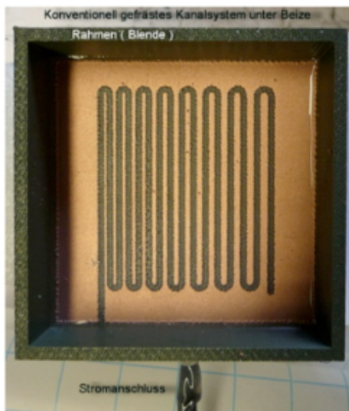
a: konventionell gefrästes Kanalsystem
