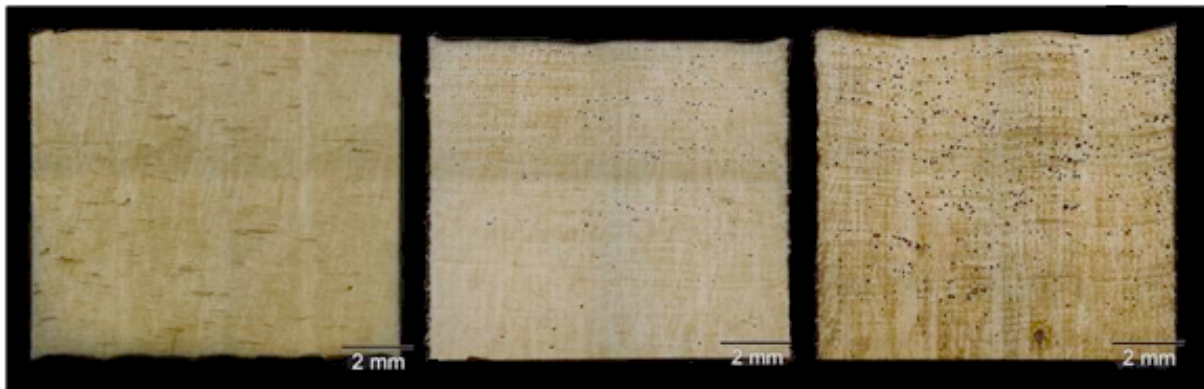
Abbildung 7: Tiefschweißeffekte und Porosität bei steigendem Punktabstand Quelle: Eigendarstellung
