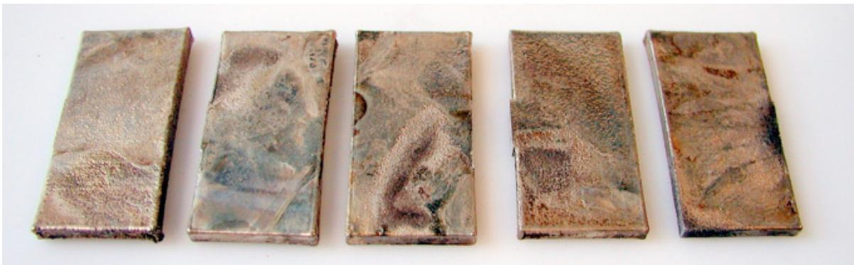
*Abbildung 6: Beschichtete, gealterte Proben*
