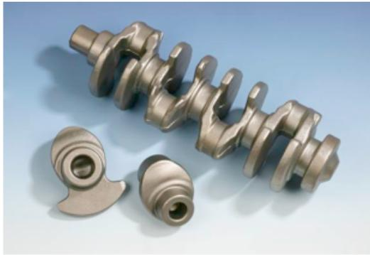
**Abbildung 1:** Konventionelle einteilige Kurbelwelle (oben) und Segmente für Leichtbau-Version mit hohlem Zapfen (unten links mit / unten rechts ohne Gegengewicht).
