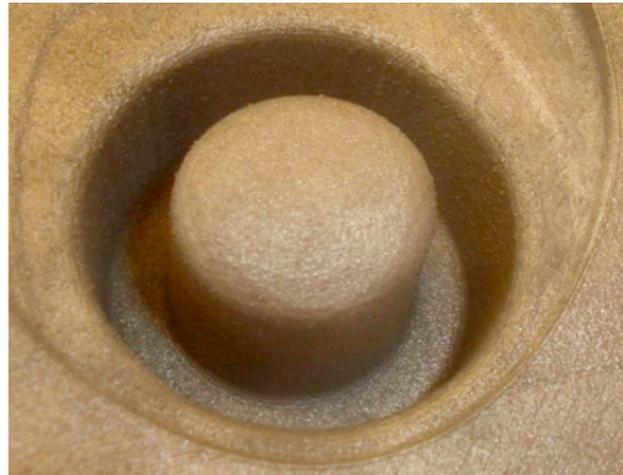
**Abbildung 6:** Dornbereich des laserstrahlgeschmolzener Gesenkeinsatzes vor dem maschinellen Polieren
