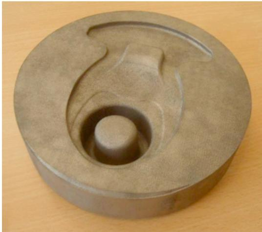
**Abbildung 5:** Laserstrahlgeschmolzener Gesenkeinsatz
