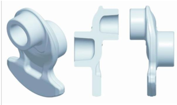
**Abbildung 2:** Geometrie des Referenzteils Kurbelwellensegment
