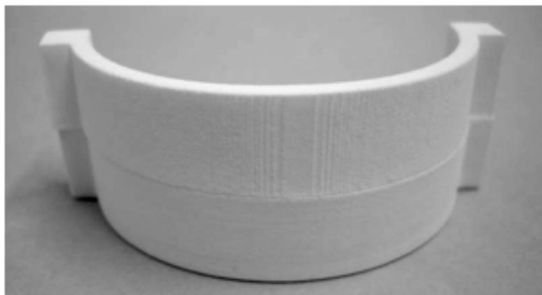
Bild 5: Treppenstufeneffekt bei gekrümmten Oberflächen
