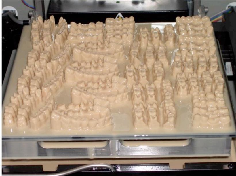
*Abb.6: Bauplattform mit zahntechnischen Modellen unmittelbar nach Bauende*
