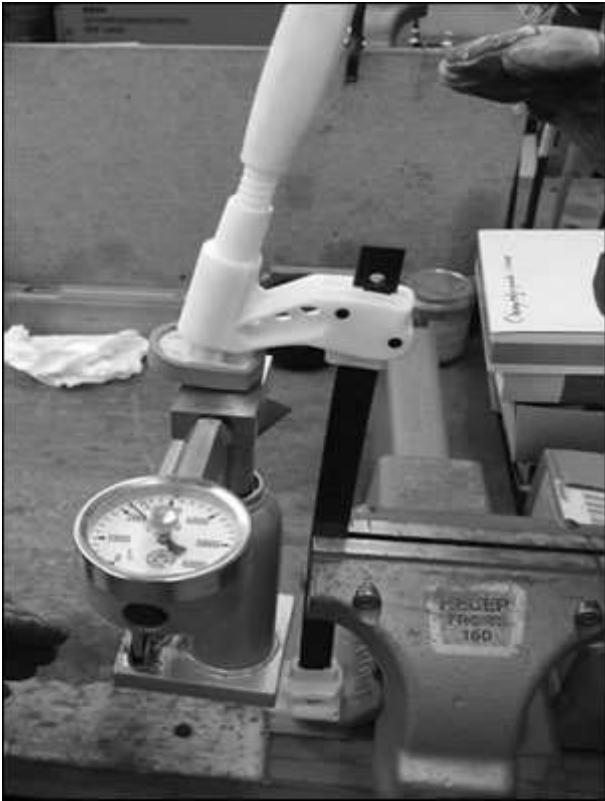
Abb. 1: Zange aus Duraform PA-HD, Belastung: 2.200 N
