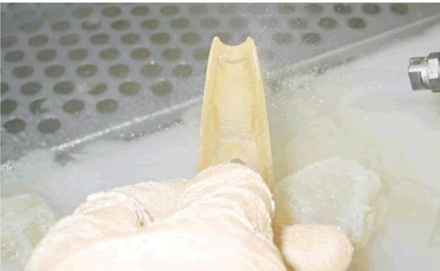
Abb. 5: Entfernen des Stützmaterials
