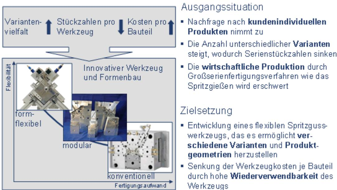
Abbildung 1: Innovationsansätze im Werkzeug- und Formenbau
