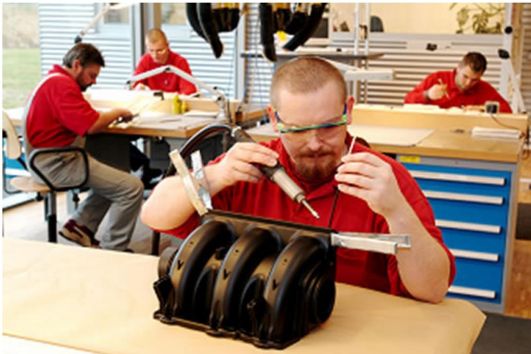
*Abb.4: Heißluftschweißen von Nylon-Mold™- Saugrohren*
