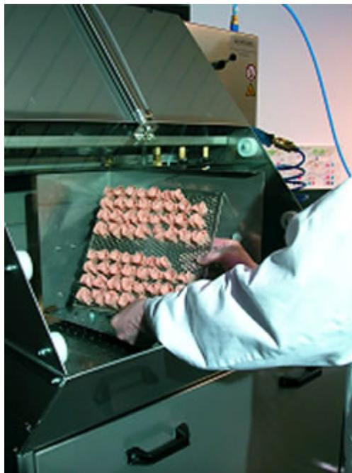
Abb.13: Reinigung einer Bauplattform in der FotoTec® Rapid Clean
