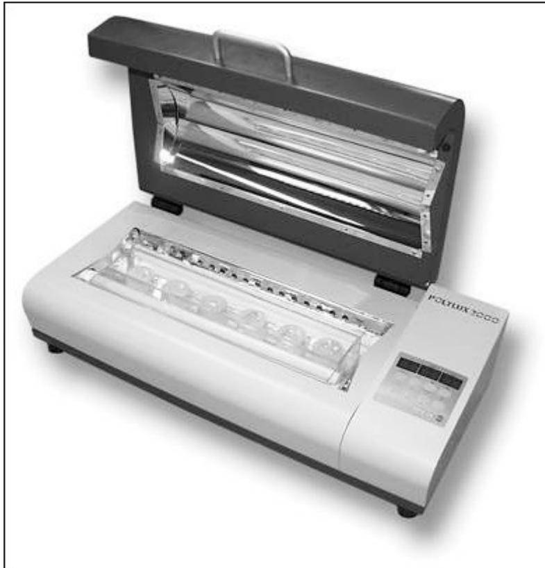
Abb.1f: Traditionelle Herstellung von Ohrpasstücken, Herstellung der Positivform
