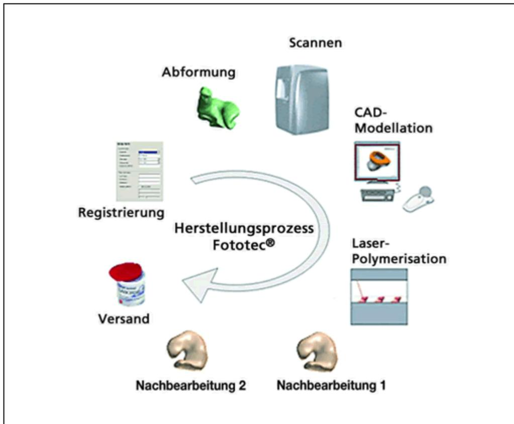
Abb.2: Prozesskette zur Herstellung von Ohrpasstücken
