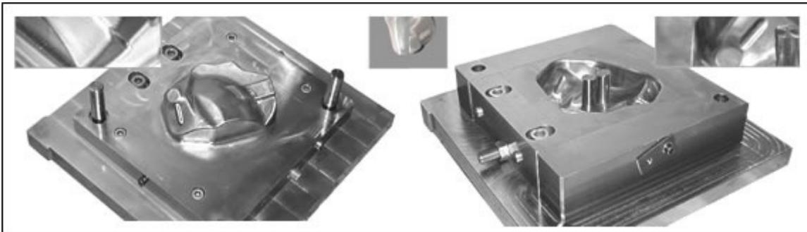
Abb.2: MELATO®-Werkzeug zum Prägen von Verbundmaterial für wärmedämmende Bauteile im Kraftfahrzeug (mitte), links: Stempel unbearbeitet, rechts: Matrize poliert
