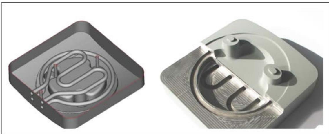
*Abb.3: Lamelliertes Spritzgusswerkzeug mit konturfolgenden Kühlkanälen; links: Kühlsystem im CAD-Modell, rechts: Schnittdarstellung des Kühlsystems im Werkzeug*
