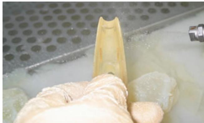
*Abb. 4: links: Modell nach Bauprozess mit Support; rechts: Entfernen des Stützmaterials*
