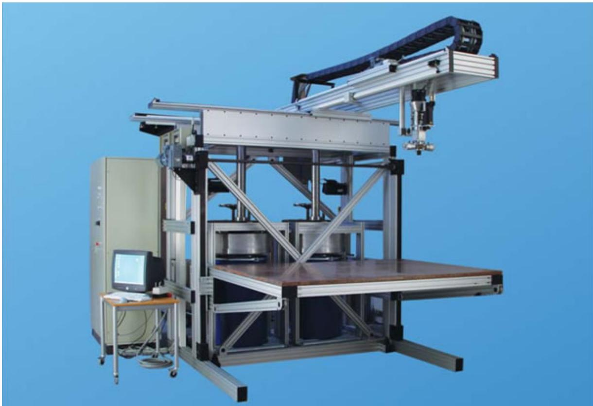
Abb.1: Der FoamJet® generiert CNC-gesteuert Modelle aus PU-Hartschaum
