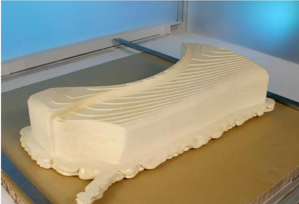
*Abb.3: Schäumen und Fräsen erfolgen in einer Aufspannung*
